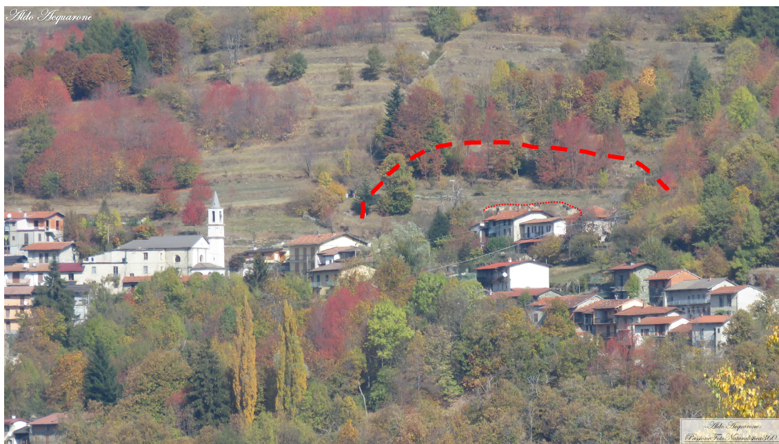
Foto n° 2: Vista dal versante opposto - il dissesto con parziale evoluzione a colata è avvenuto a carico dei terreni di copertura nell'ambito di un largo impluvio a valle del quale sono presenti le abitazioni della borgata. Un coronamento molto più esteso evidenzia l'effettivo sviluppo del settore in dissesto incipiente
